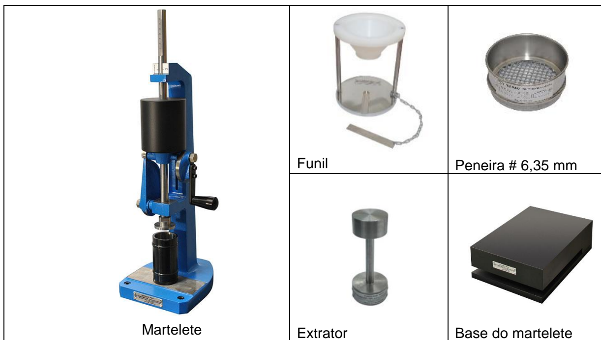
Figura 2 – Foto ilustrativa de um martelete medidor de compactabilidade e seus acessórios.
